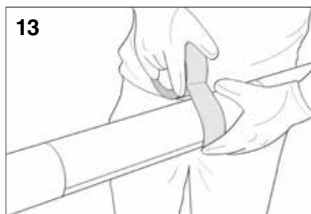
Die Muffe mit einem Klebeband fixieren.
