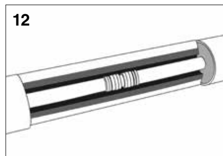
Die abgelängten Isolierhalbschalen in den Muffenhohlraum einbringen.
