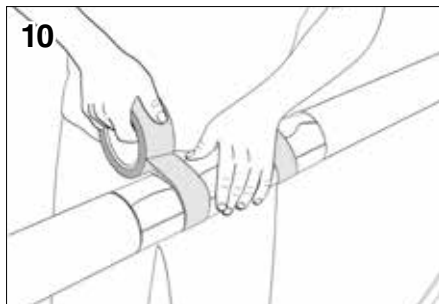
10 Leckwarndrähte mit einem Klebeband fixieren.
