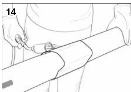
14 Die Anbringungsstelle der KTD-Manschetten mit Ethanol reinigen und mit einem Schmirgelleinen (Korn 40-60) quer über die Rohrleitungsrichtung aufrauen. Schutzfolie von KTD-Manschetten entfernen. Die Anbringungsstelle der Manschetten mit Propangasflamme vorwärmen. Warten bis die Oberfläche langsam auf 60°C erwärmt.
