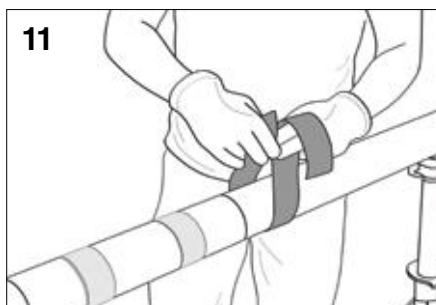
11 Ausrichtung der Muffe mit einem Markierstift positionieren. Anschließend sind die Abdichtflächen mit einem Schmirgelleinen (Korn 40-60) aufzurauen.
